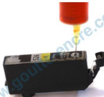
Rebouchez ensuite le trou avec une goutte de colle chaude (idéal) ou du silicone. Plus le trou que vous avez réalisé est petit, plus il sera simple de le reboucher. Le trou doit être parfaitement étanche.
