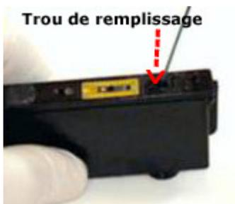
4. Injecter très doucement l'encre jusqu'à ce que l'encre apparaisse au trou de remplissage. (max 7,5ml pour les cartouches couleur et 14ml pour la cartouche noire Lexmark 100XLA)
